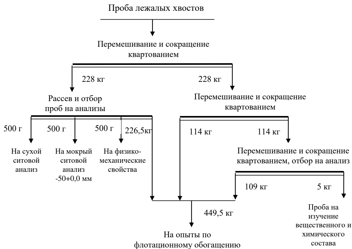
Рисунок 1 – Схема подготовки и разделки пробы
